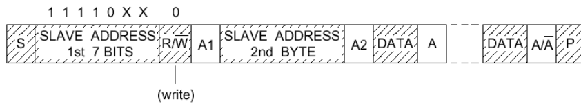
图 26 主机一发送器用 10 位地址寻址从机一接收器
